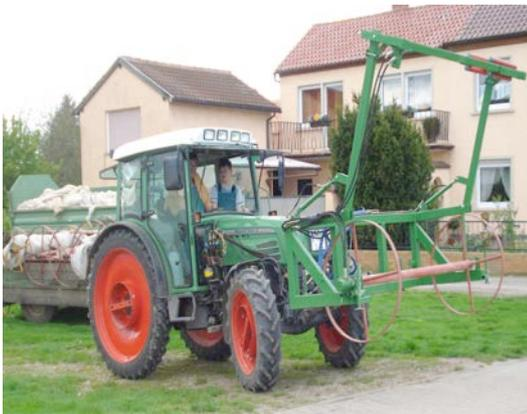
Durch das Raffen der Taschenfolie wird eine gleichmäßige Verteilung auf Folienbreite erreicht. Beim Auswickeln legt sich die Folie wieder mittig auf den Damm.
